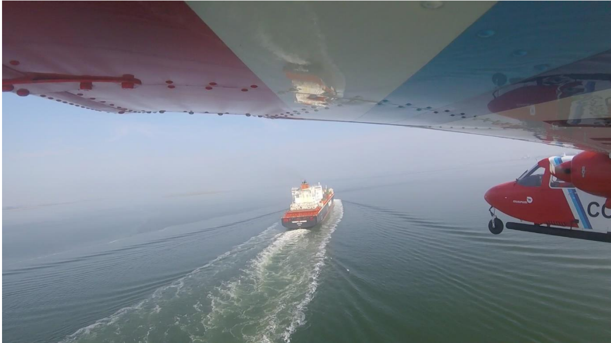
Aanvliegen van een schip voor controle van de zwavel-, stikstof- en zwarte koolstof-uitstoot. © KBIN/BMM
