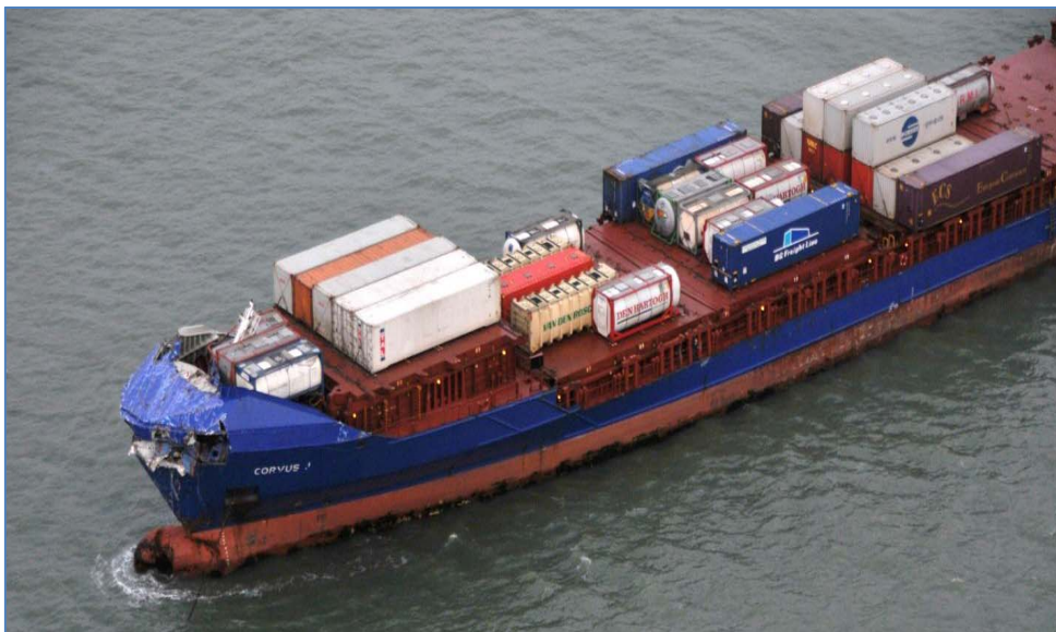
Figuur 8: Het schip 'Corvus J' met ernstig beschadigde boeg na aanvaring met de 'Baltic Ace' (6/12/2012).
