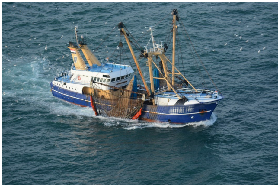
Figuur 71. Nederlands vissersvaartuig (boomkor) actief in het Belgische deel van de Noordzee.
