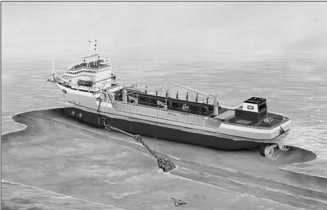
Figuur 2.5-1: Visualisatie van ontginning met een sleepopperzuiger (presentatie Geert De Poorter, Studiedag Zandwinning, 2014)
