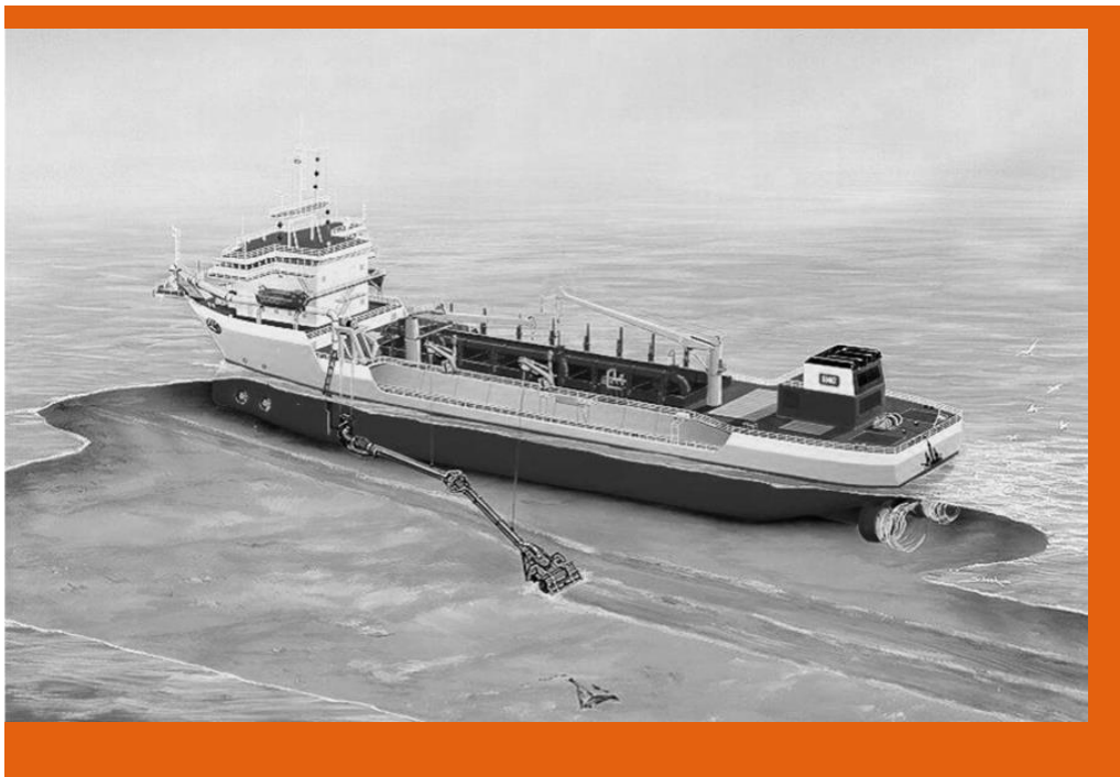
Figuur 2.5.1: Visualisatie van ontginning met een sleephopperzuiger (presentatie Geert De Poorter, Studiedag Zandwinning, 2014)
