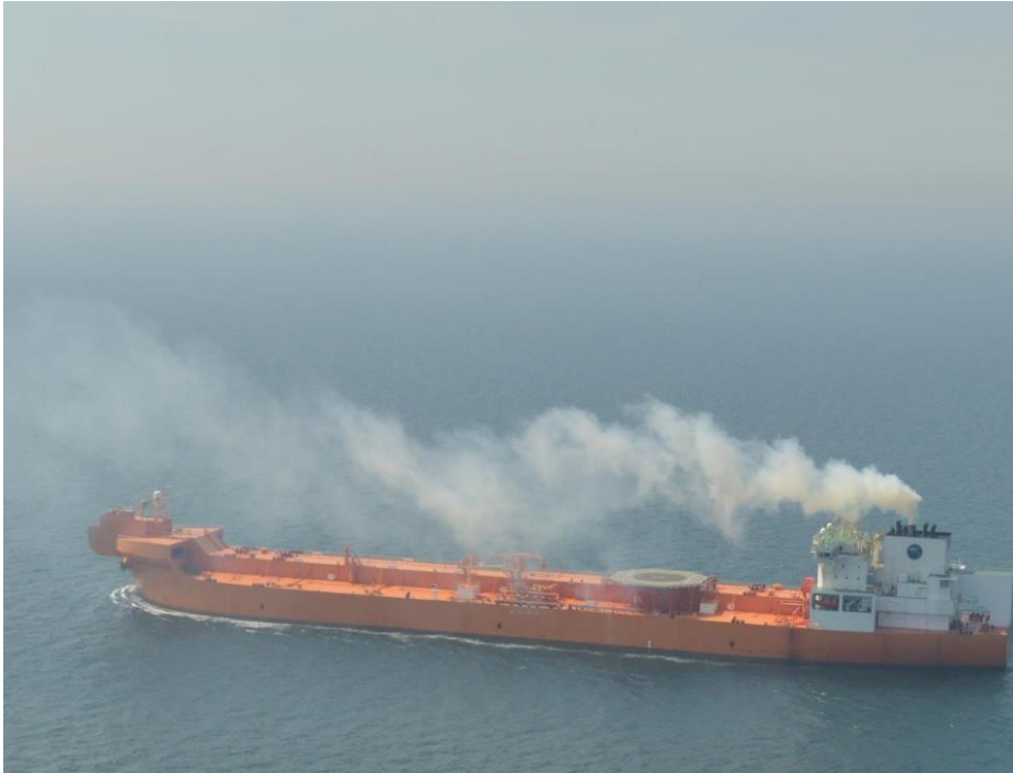
Het zwavelgehalte in de uitstoot van schepen op zee kan dankzij de sniffertechnologie worden gemeten op zee © KBIN/BMM
